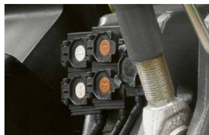
In combinatie met de frontheinrichting zijn maximaal vier hydraulische aansluitingen en een vrije retour aan de voorzijde leverbaar. Ideaal voor een zaadtank of schuifblad aan de frontheinrichting.
