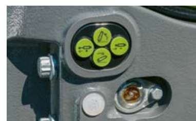
CEBIS uitvoering beschikt over een externe bediening van de fronthefinrichting en een regelventiel.
