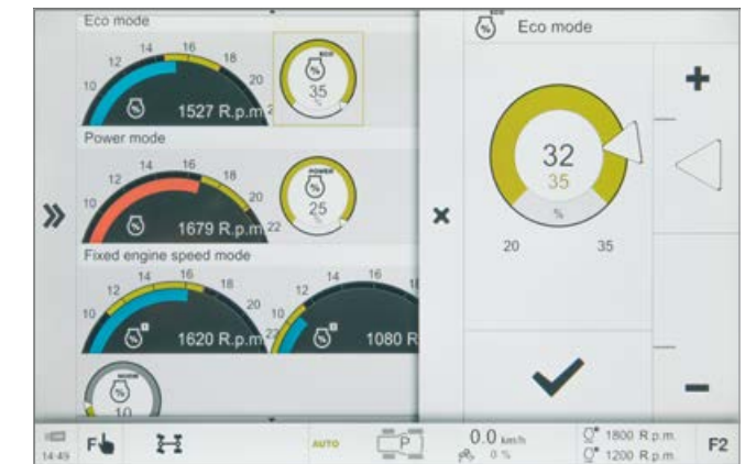
Instelling van de motordrukking voor 'Eco' en 'Power', evenals het motortoerentalgeheugen
