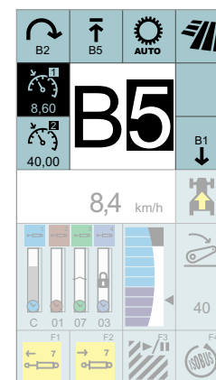
Intelligente keuze van de versnellingen met het display op de A-stijl bij de CIS uitvoering.
