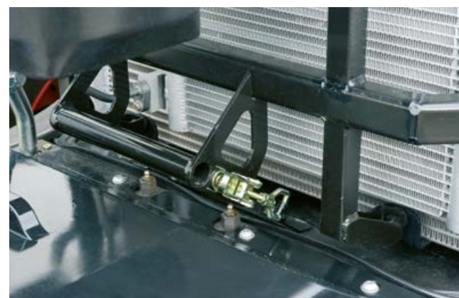
Smeerpunten van de vooras zijn optimaal bereikbaar voor het koelerpakket.
