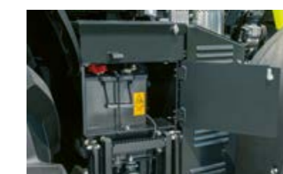
Bateria este amplasată deasupra scării de acces din partea dreaptă, fiind ușor de accesat.
