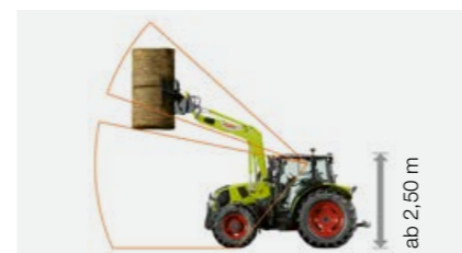
Niedrigdachkabine mit Glasdachluke: Durchfahrts Höhe ab 2,50 m.
