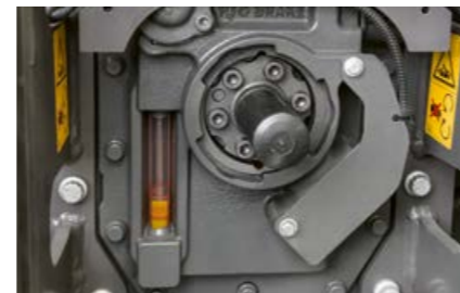
Den Ölstand von Getriebe und Hydraulik kontrollieren Sie über ein Schauglas neben der Zapfwelle.
