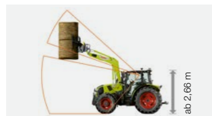
Hochdachkabine mit Glasdachluke: Durchfahrts Höhe ab 2,66 m.
