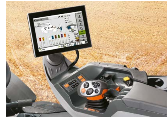
▲ Лесно управление. Интуитивна настройка на машината и оптимален комфорт на обслужване с бордовата информационна система CEBIS и мултифункционалния лост за управление CMOTION.
