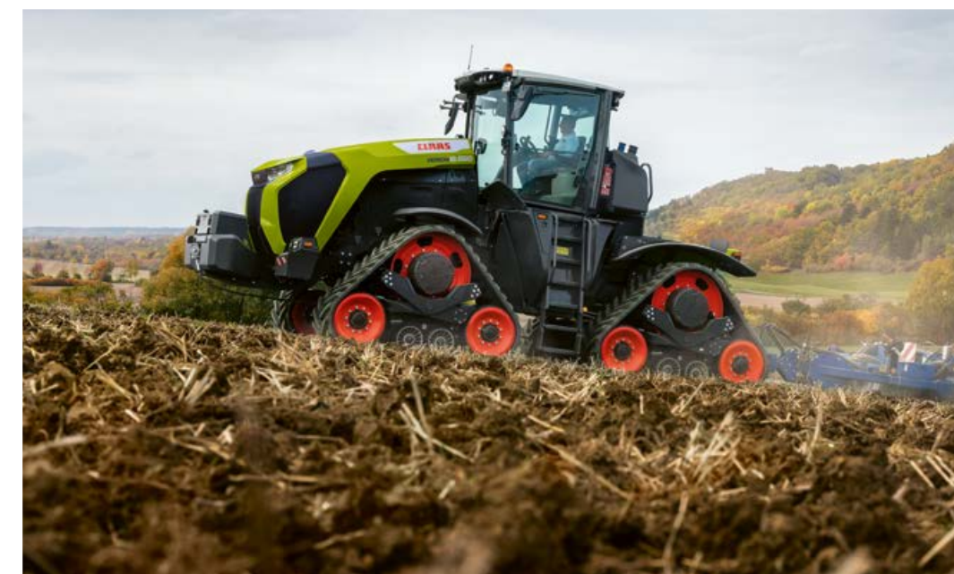
▲ Концепцията на окачването, от окачването на гумените вериги до 4-точковото окачване на кабината и седалката премиум клас, осигурява особено високо ниво на комфорт при движение в XERION.
