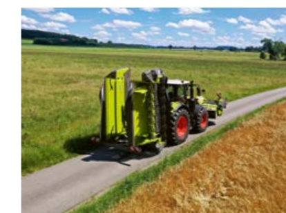
Kompakte Transportposition für sichere Straßenfahrten.
