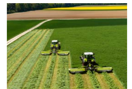
Zusatzschwadbleche für ein engeres Schwad.
