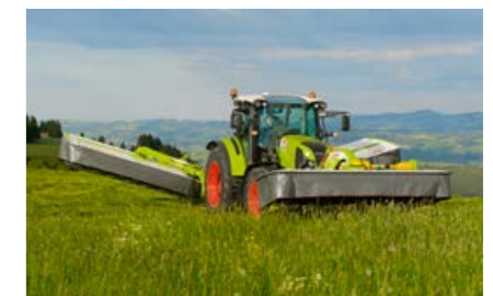
Durch die kompakte Aufhängung am Fronthubwerk verfügt das Mähwerk über große Bodenfreiheit am Vorgewende.
