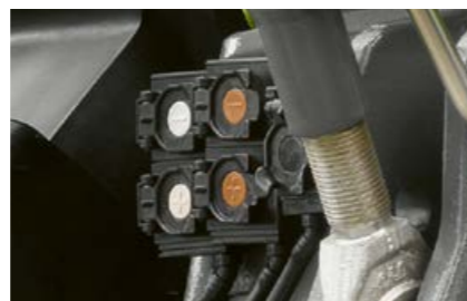
A frontfüggésztés mellé két kihelyezett kör és szabad visszafolyó ág elérhető. Ideális magtartályhoz, vagy akár egy tolólaphoz.
