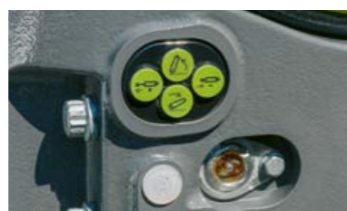
Външно обслужване на предната навесна система и един уред за управление с оборудване CEBIS.
