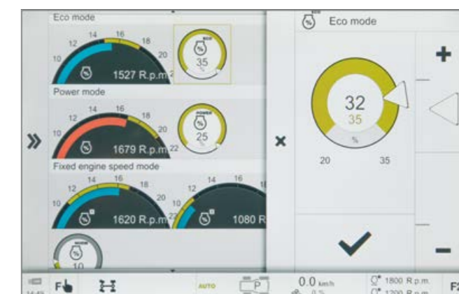
Настройка на натоварването на двигателя за „Eco“ и „Power“, както и на запаметяването на оборотите на двигателя
