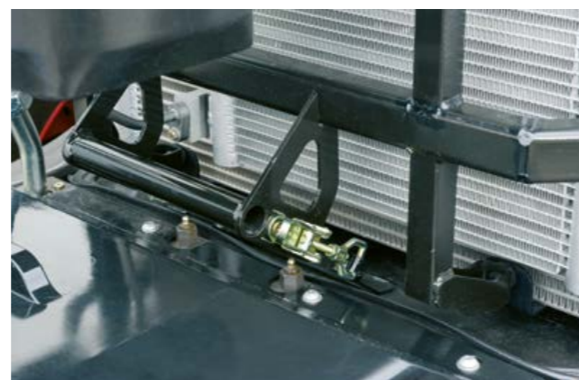
Места за смазване на предния мост пред охладителния пакет за оптимален достъп.
