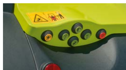
Външен обслужващ елемент за задна навесна система, силоотводен вал и уред за управление по избор (само CEBIS).
