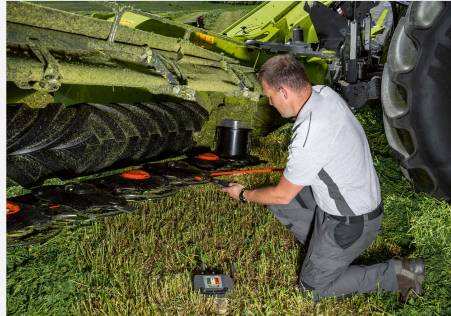
Die Ersatzmesser werden in einer regendichten Box am Mähwerk aufbewahrt, sodass ein Wechsel direkt auf dem Feld problemlos möglich ist. Der Austausch der Messer erfolgt schnell und unkompliziert mit dem im Mähwerk integrierten Montagehebel.
