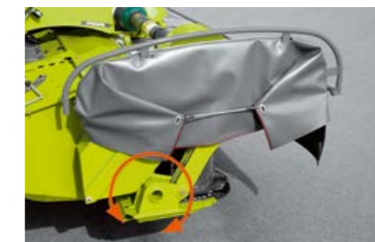
Durch den tief sitzenden Drehpunkt folgt das DISCO PROFIL dem Boden und nicht dem Traktor.
