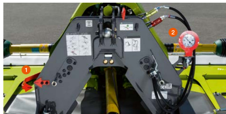
1 Einstellung Arbeitshöhe, 2 ACTIVE FLOAT Manometer
