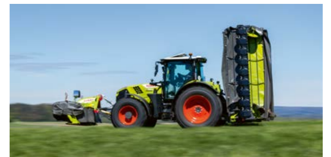
Unter 4 m: kompakte Transportstellung für sichere Straßenfahrt.
