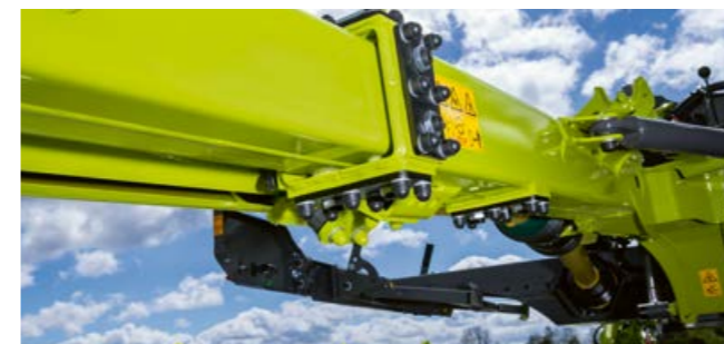
Zwei hydraulisch steuerbare Teleskopausleger mit stufenloser Einstellung für optimale Überlappung beim DISCO 1100 COMFORT.
