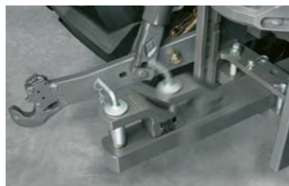
Warianty zaczepów polowych oferują wiele możliwości. Wysunięta pozycja zaczepu dolnego umożliwia lepszą zwrotność.
