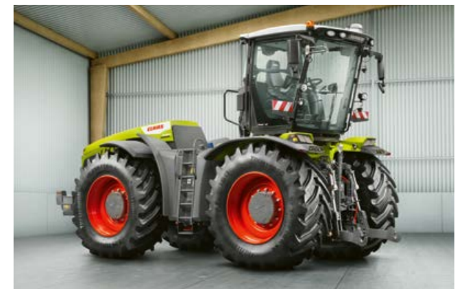
TRAC VC pune la dispoziție cel mai confortabil sistem cu cabină reversibilă de pe piață. Cabina sa poate fi rotită la 180° în mai puțin de 30 de secunde.
