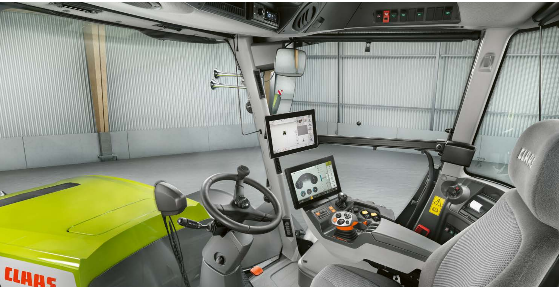
TRAC VC pune la dispoziție cel mai confortabil sistem cu cabină reversibilă de pe piață. Cabina sa poate fi rotită la 180° în mai puțin de 30 de secunde.
