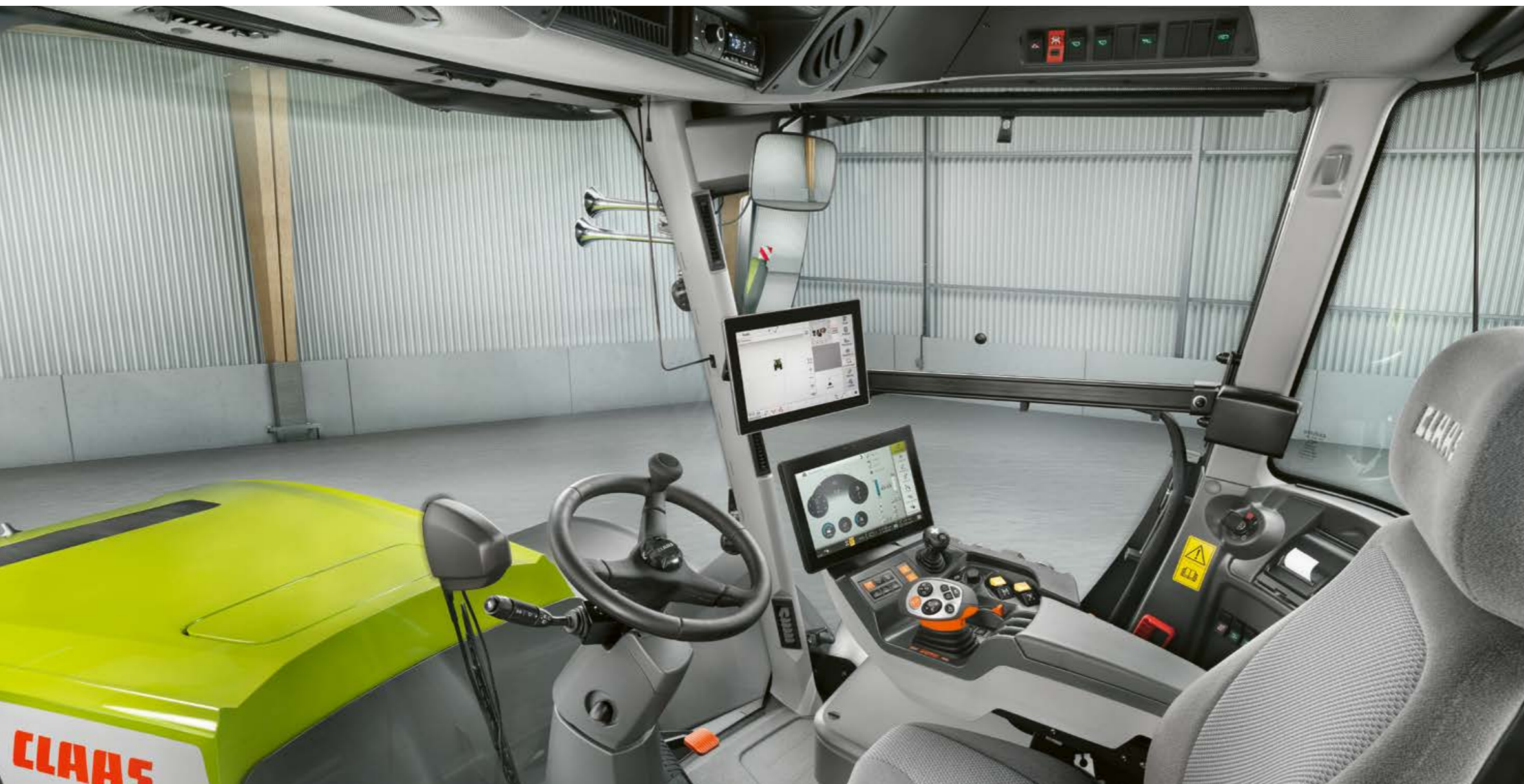
TRAC VC ma najbardziej komfortowy na rynku system jazdy tyłem. Kabinę można obracać o 180° w czasie krótszym niż 30 sekund.
