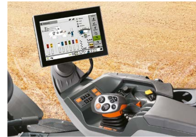
▲ Facile da comandare. Impostazioni intuitive della macchina e ottimo comfort di comando con il sistema d'informazione di bordo CEBIS e la leva multifunzione CMOTION.
