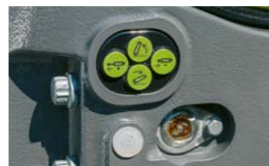
Manejo externo para el elevador delantero y un distribuidor hidráulico con el equipamiento CEBIS.
