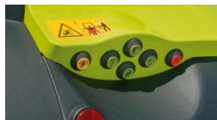
Vanjske kontrole za stražnju podiznu hidrauliku, kardansko vratilo i upravljačku jedinicu koja se može odabrati (samo CEBIS).
