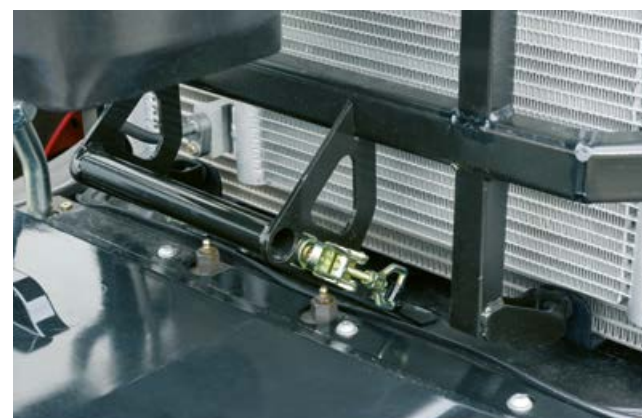
Punti di lubrificazione dell'assale anteriore davanti al gruppo radiatori per un facile accesso.
