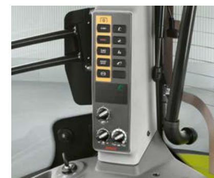
Velocità delle prese di forza e regolazione elettronica del sollevatore posteriore regolabili sul montante B.
