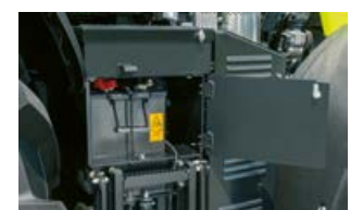
La batteria è posizionata ben accessibile a destra della scaletta per salire in cabina.
