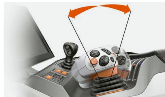
Comando progressivo con la tecnologia della trasmissione a variazione continua CMATIC.
