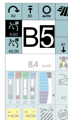
Inteligentny wybór biegu na słupku A wyświetlacza w wersji CIS.
