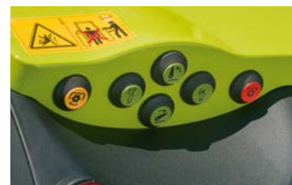
Zewnętrzna obsługa tylnego WOM na obu błotnikach.
