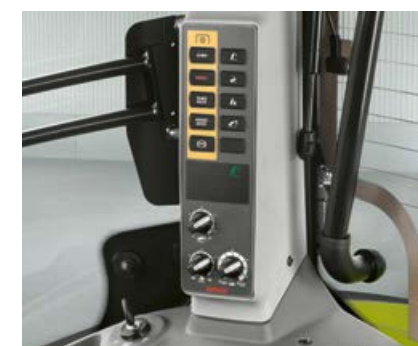
Prędkości WOM oraz elektroniczna regulacja tylnego podnośnika na słupku B.
