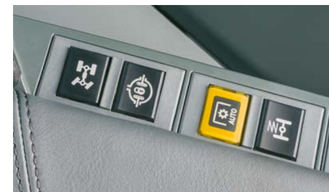
Aktywacja amortyzacji przedniej osi.
