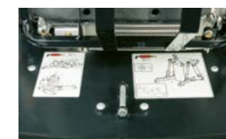
Pod maską silnika znajduje się harmonogram smarowania, który ułatwia proces konserwacji.
