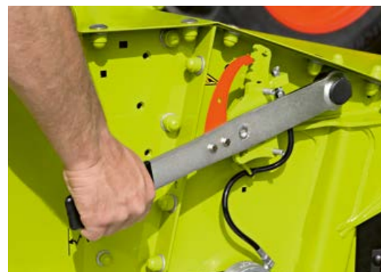
Intensidad del acondicionador
