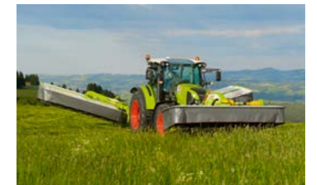
Con el enganche compacto en el mecanismo de elevación delantero, la segadora dispone de una gran distancia libre al suelo en cabeceras.
