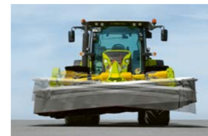
Adaptación transversal a la dirección de avance con el enganche que gira libremente.
