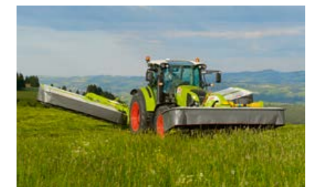
Con el enganche compacto en el mecanismo de elevación delantero, la segadora dispone de una gran distancia libre al suelo en cabeceras.
