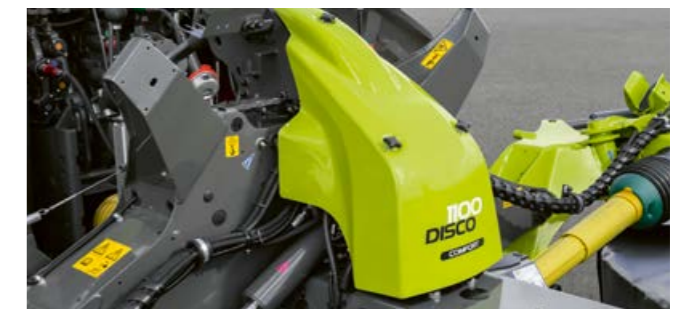
Soporte de enganche compacto y estable con sistema de descarga integrado de serie ACTIVE FLOAT.
