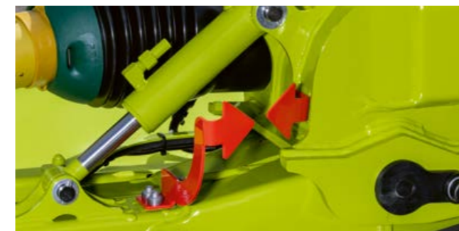
Ajuste sencillo de la altura del bastidor central: Las puntas de las flechas tienen que señalar la una a la otra.
