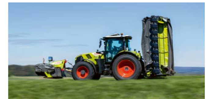
Por debajo de 4 m: Posición compacta de transporte para una circulación segura por carretera.
