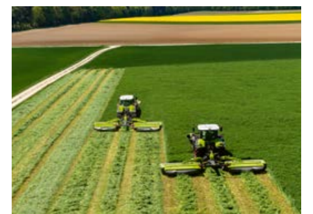
Chapas hileradoras adicionales para una hilera más estrecha.
