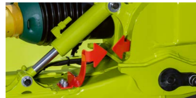
Regolazione semplice dell'altezza del telaio centrale: le punte delle frecce devono essere rivolte una verso l'altra.
