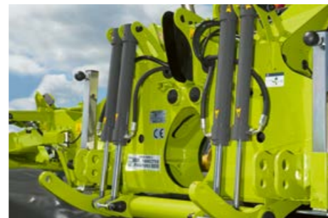
I cilindri di sollevamento e scarico del peso dell'ACTIVE FLOAT assicurano una protezione ottimale della cotica erbosa.
