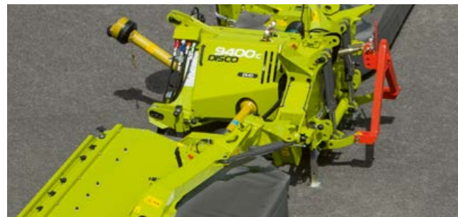
Protezione contro gli urti tramite dispositivo anticollisione non stop a comando idraulico: l'unità falciante si piega all'indietro e ritorna automaticamente alla posizione iniziale.
