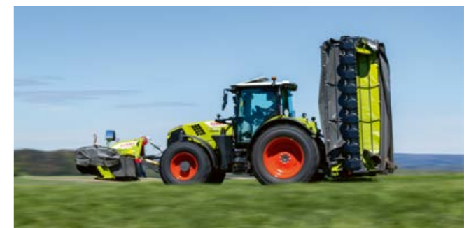
Al di sotto di 4 metri: posizione di trasporto compatta per spostamenti su strada sicuri.
