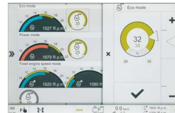
Настройка снижения частоты вращения двигателя для режимов Eco и Power, а также для настройки ячейки памяти оборотов двигателя.
