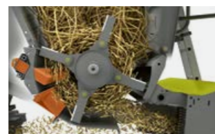
Contracuchilla y elemento giratorio de fondo en el picador SPECIAL CUT
