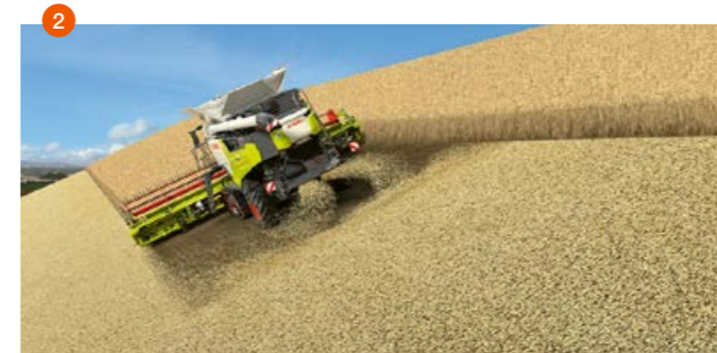
1 En el caso de pendiente, se adapta automáticamente la dirección de tiro. 2 El material picado es repartido homogéneamente por toda la anchura de trabajo.
