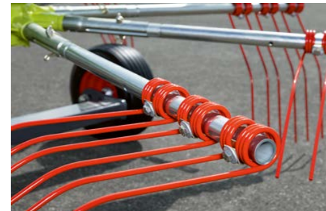
Werkzeuglose Abnahme der Zinkenträger.
