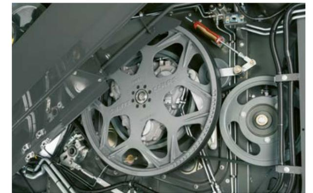
Auch bei der mechanischen Variante brauchen Sie für die Verstellung kein Werkzeug. Wenn Sie noch mehr Zeit sparen wollen, entscheiden Sie sich für die hydraulische Verstellung (optional). Damit erledigen Sie die Anpassung bequem aus der Kabine heraus.
