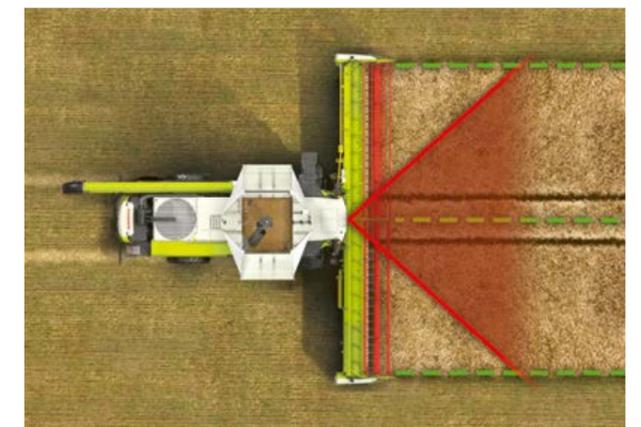
LASER PILOT mit FIELD SCANNER
