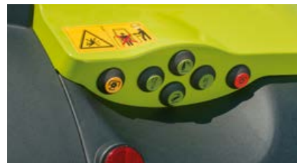
Commandes extérieures pour le relevage arrière, la prise de force et un distributeur au choix (CEBIS uniquement).
