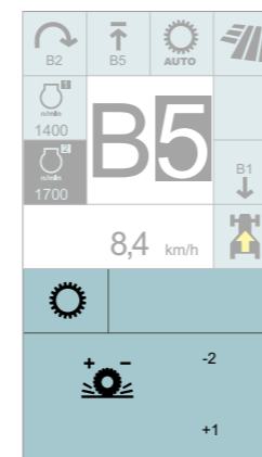
Progressivité de l'inverseur REVERSHIFT avec le CIS.
