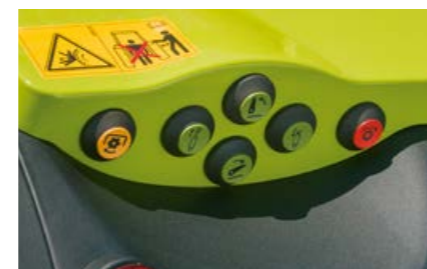
Commandes extérieures de la prise de force arrière déportées sur les deux ailes.
