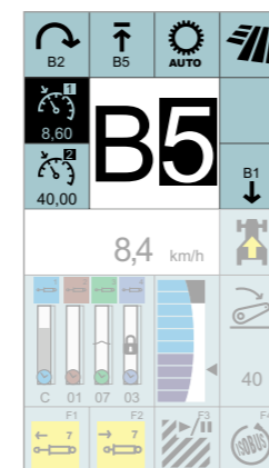
Sélection intelligente du rapport sur l'affichage du montant droit de la définition CIS.
