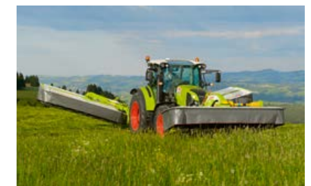
Kompaktowe zawieszenie na przednim podłożniku zapewnia duży prześwit na uwrociach.
