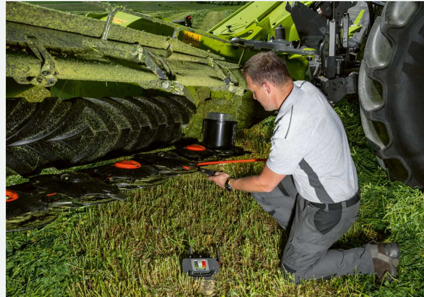
Zapasowe noże są przechowywane w wodoszczelnej skrzynce na kosiarce, co umożliwia ich wymianę bezpośrednio na polu. Dźwignia montażowa wbudowana w kosiarkę zapewnia szybką i łatwą wymianę.
