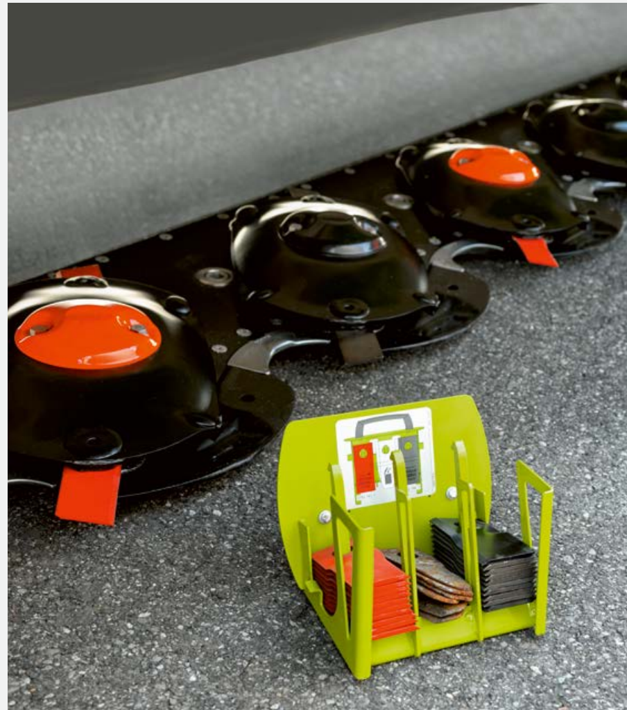
Obracające się w lewo tarcze tnące oraz przynależne noże są zawsze oznakowane kolorem czerwonym.
