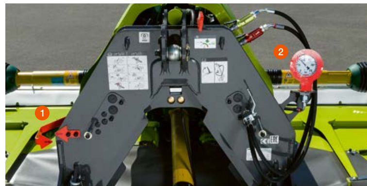
1 Ustawienie wysokości roboczej, 2 Manometr ACTIVE FLOAT
