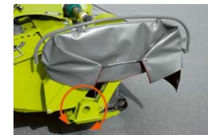
Dzięki nisko osadzonemu punktowi obrotu DISCO PROFIL podąża za konturami podłoża, a nie za ruchami ciągnika.
