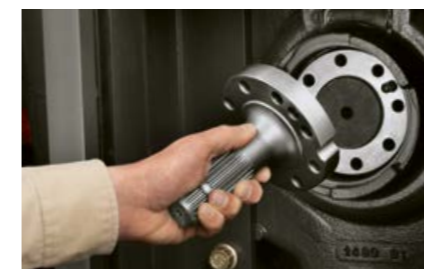
Einfacher Wechsel der Zapfwellenstummel.
