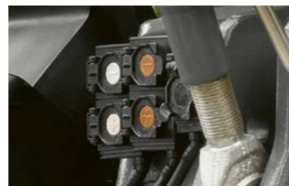
In Verbindung mit dem Frontkraftheber sind bis zu vier hydraulische Anschlüsse und ein freier Rücklauf an der Front erhältlich. Ideal für einen Saattank oder ein Schiebeschild im Frontanbau.
