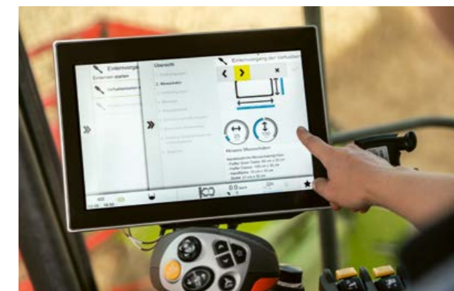
Wprowadzenie wymiarów dostępnego pojemnika do pomiaru strat w CEBIS
