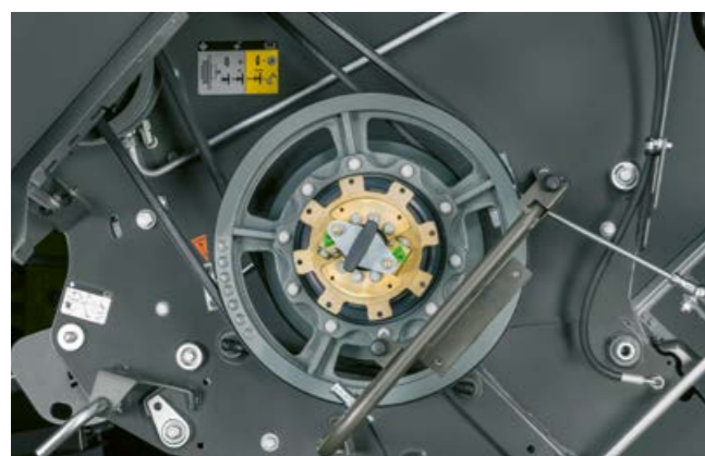
Liczbę obrotów siekacza słomy można dostosować do warunków pracy w łatwy, szybki i niewymagający użycia narzędzi sposób.
