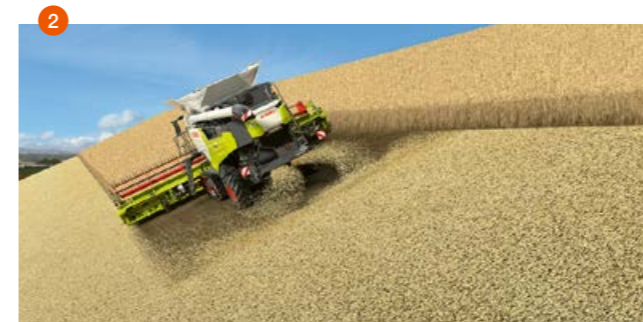
1 Na zboczu jest on dopasowywany automatycznie. 2 Sieczka jest rozdzielana równomiernie na pełną szerokość roboczą.
