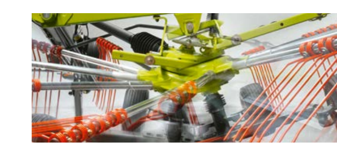
La sospensione flottante delle giranti: le giranti si adeguano al suolo, indipendentemente dal trattore.
