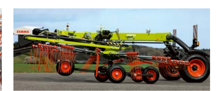
Effetto JET: durante il sollevamento o l'abbassamento la girante si comporta come un aereo in fase di decollo o atterraggio.
