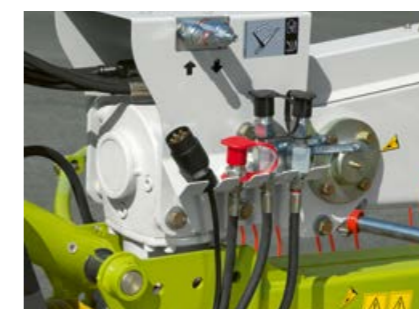
Control hidráulico secuencial de serie para ajustar el retardo entre el rotor delantero y el trasero al subirlos y bajarlos.
