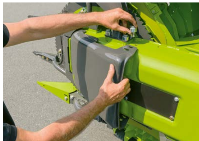
Gleitkufen mit zweistufiger Höheneinstellung.
