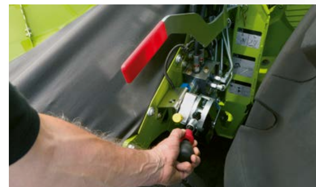
Dreistufige Drehzahlenpassung der Einspeisetrommeln für optimalen Gutfluss.
