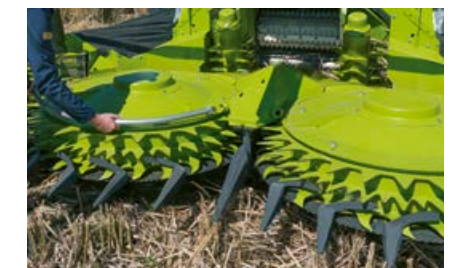
Demontage der Kolbenfallen erhöht die Gutflusstauglichkeit.
