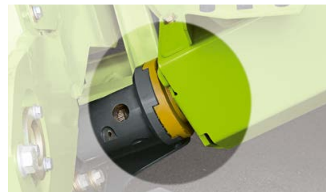
Kraftübertragung über Schnellkuppler.
