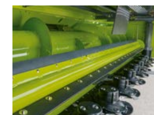
DIRECT DISC 600 P / 500 P mit höhenstellbarer Paddelwalze, optional hydraulisch.
