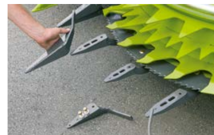
Demontierbare Einweiserfinger verbessern das Aufheben von Lagermais.
