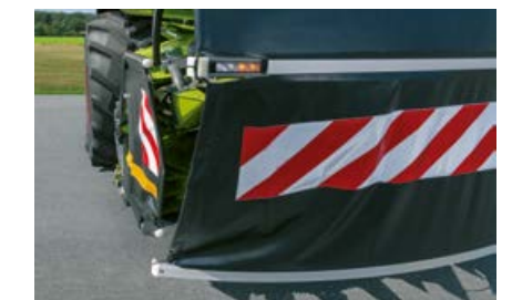
Seiten- und Frontschutz sind mit Warnaufklebern gut sichtbar. Die LED-Beleuchtung ist voll integriert.
