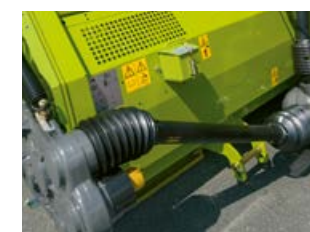
Leistungsstarker Antriebsstrang mit dreistufigem Getriebe.
