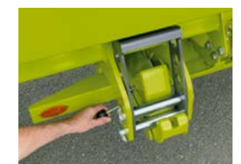
Nach Verriegelung sicher unterwegs bei Geschwindigkeiten bis 40 km/h.
