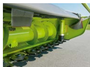
DIRECT DISC 600 / 500 mit groß dimensionierter Einzugschnecke.
