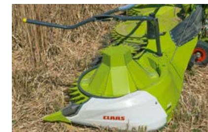
Der große Lagermaiskegel optimiert den Gutfluss und verhindert den Verbleib von Erntegut auf der Transportscheibe.
