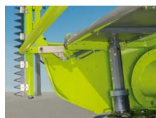
Einstellbare Niederhalter, optional auch hydraulisch.
