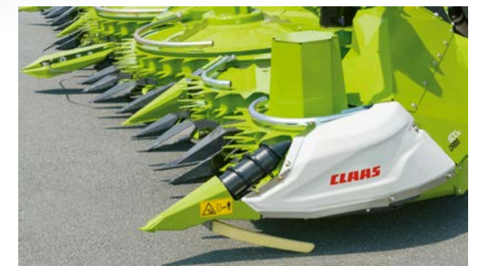
Im Bedarfsfall erfolgt der Antrieb der Lagermaisschnecken hydraulisch.
