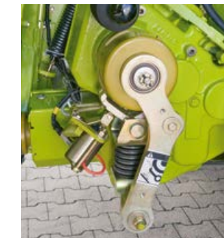
Embrague interruptor del detector de metales
