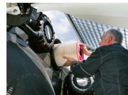
Cambio del filtro de aire sin herramientas
