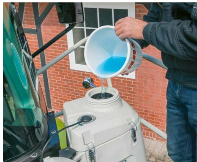
Relleno del depósito de aditivos de ensilado
