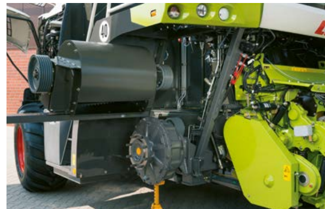
Sencillo desmontaje y montaje del acelerador
