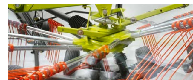
Kardanowe zawieszanie wimików: wimiki dostosowują się do konturów gleby – niezależnie od ciągnika.
