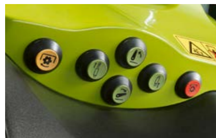
Ārējās vadības ierīces aizmugures uzkares, jūgvārpstai un vienam hidraulikas izvadam pēc jūsu izvēles
