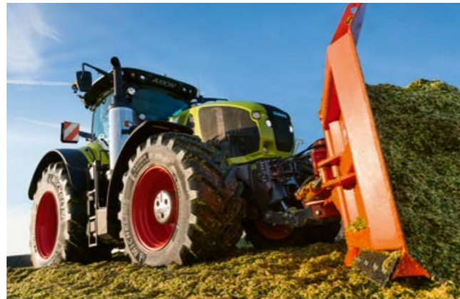
Ja ir uzstādīta priekšējā uzkarē, tad priekšā ir pieejami viens vai divi divpusējas darbības hidrozvadi un viena brīvas plūsmas atpakaļ atgriešanās līnija. Tas ir ideāli, ja jāstrādā ar priekšā uzstādītu sēklu tvertni vai ar buldozera lāpstu.
