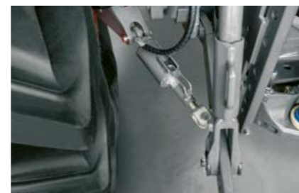
Izvēles opcija ir hidrauliskie sānu stabilizatori – tie nodrošina lielāku drošību un atvieglo darbu
