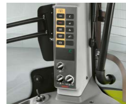
Voimanottonopeuden ja sähköisesti ohjatun nostolaitteen säätö tehdään B-pilarissa.
