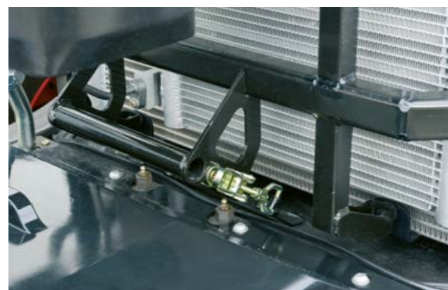
Etuakselin voitelukohdat ovat jäähdyttimien etupuolella käsiksi pääsyn varmistamiseksi.
