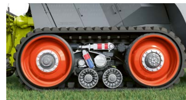
Surface de contact au sol totale de 100 % : les chenilles touchent entièrement le sol.
