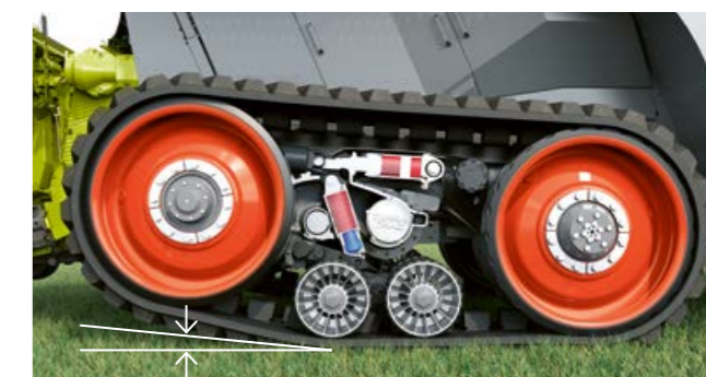
Surface de contact au sol réduite de 66 % : une partie des chenilles se relève dans les virages.
