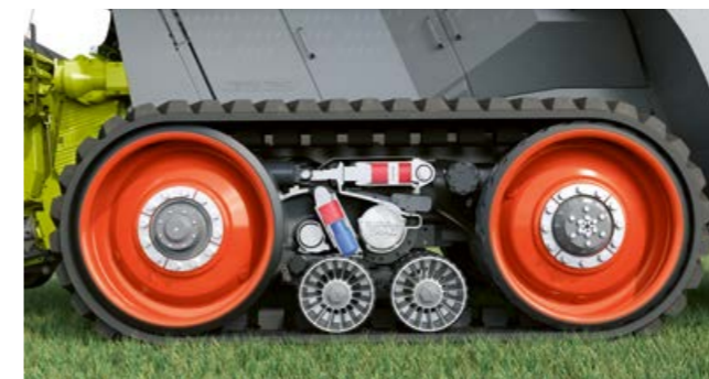
100% di superficie di appoggio: il rullo di scorrimento è completamente a contatto con il suolo.
