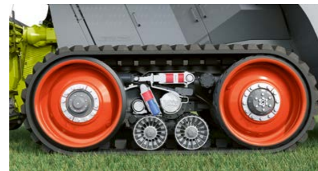
Powierzchnia przylegania 100%: rolka jezdna ma pełny kontakt z podłożem.
