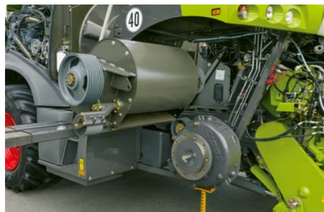
Sencillo desmontaje y montaje del acelerador
