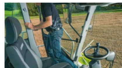
El interruptor del asiento desconecta automáticamente el cabezal y el accionamiento principal.
