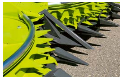
通过适用于薄壁作物的狭窄中间分禾器尖实现更加干净的作物分离。
