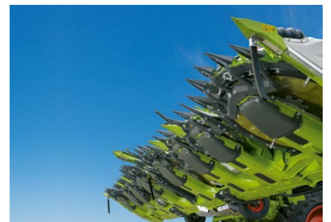
在割台的整个宽度上实现可靠地面仿形。
