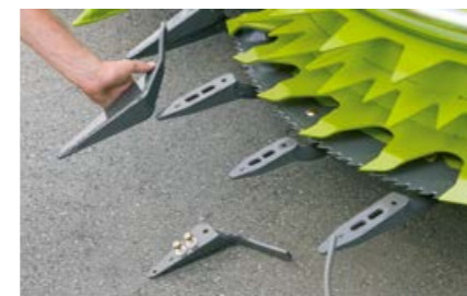
可拆卸的分禾夹爪改善倒伏玉米提升效果。
