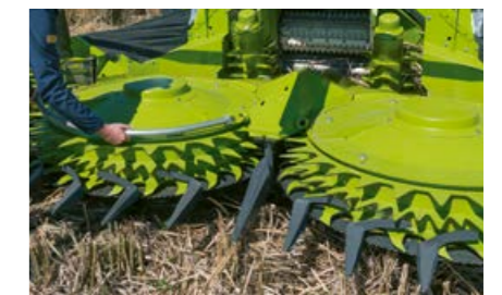
拆卸活塞式挡爪可增加作物流适用性。
