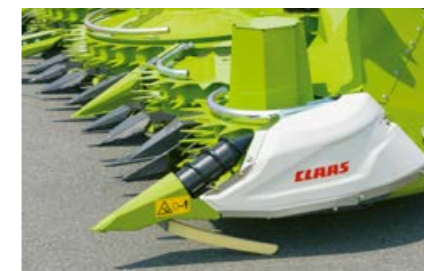
以液压形式驱动倒伏玉米尖端。
