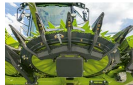
刀盘下的分禾夹爪和刮板结实耐用，带来干净整洁的作业效果。
