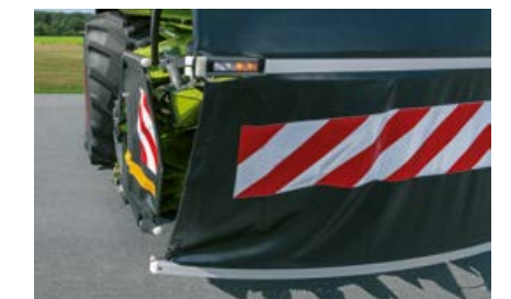
侧面和正面保护装置配有警示标志，能见度非常好。LED照明系统完全集成在内。
