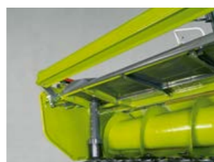
辊筒压料器带来非常均匀的收获物导向效果。
