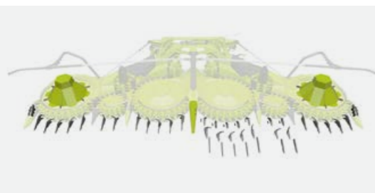
倒伏玉米锥形装置、分禾元件和尖端延长件作为附加设备。
