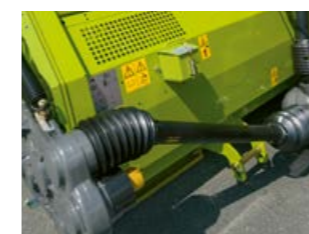
配备三级变速箱的性能强劲的传动系。
