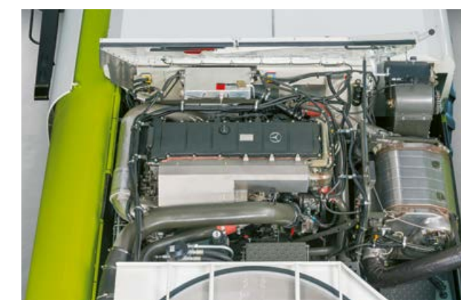
LEXION 8700 avec moteur Mercedes-Benz OM 473 LA de 460 kW / 626 ch
