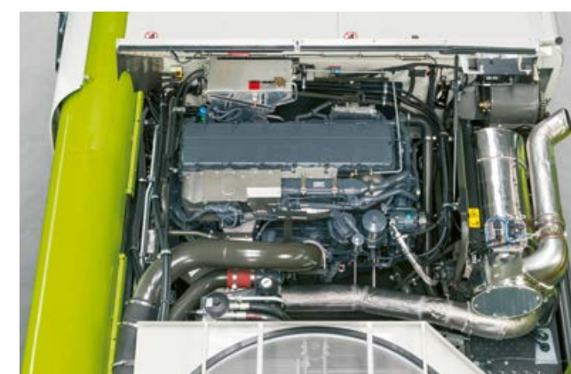
LEXION 8900 avec moteur MAN D42 de 581 kW / 790 ch
