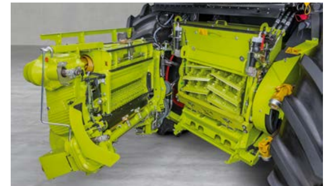
Fácil acceso al tambor para un mantenimiento rápido y sencillo.
