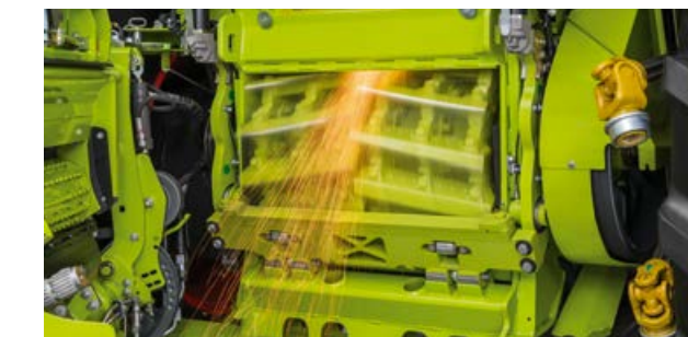
El afilado y el ajuste de la contracuchilla casi no requiere tiempo.
