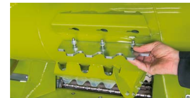
Sinfín de alimentación con cuatro palas transportadoras
