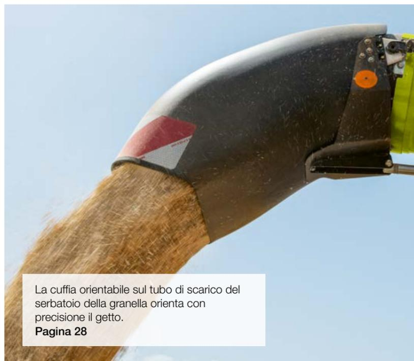
La cuffia orientabile sul tubo di scarico del serbatoio della granella orienta con precisione il getto.
