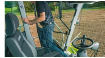
Le détecteur de présence arrête automatiquement l'outil et l'entraînement principal.
