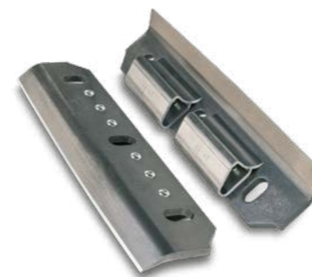
Couteaux V-FLEX universels et maïs disponibles. - Cales de ventilation rivetées sur les couteaux - Revêtement spécial de 23 mm contre l'usure
