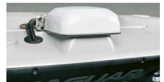
Récepteur et antenne SAT 900 dans un boîtier avec protection antivol
