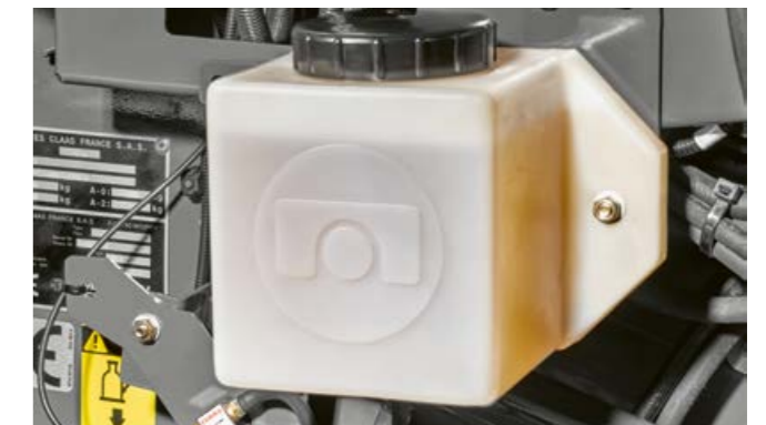
Lubrifiere permanentă a lanțurilor.
