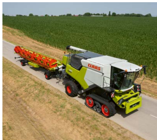
Все гусеничные шасси TERRA TRAC подходят для движения по дорогам со скоростью до 30 км/ч и удобнее в управлении, чем колесные машины.
