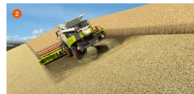
1 При работе на склоне направление разбрасывания регулируется автоматически.
