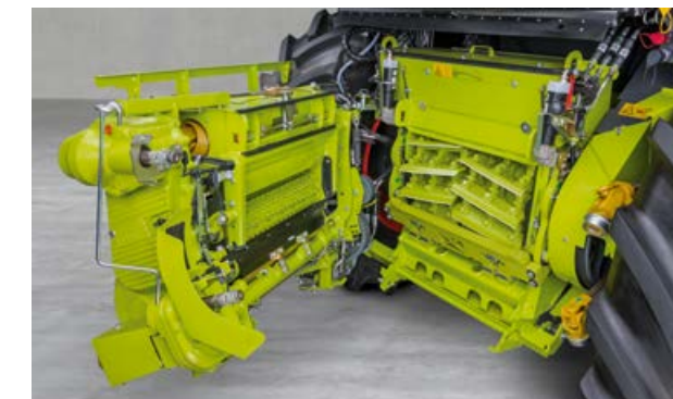
Tamburo facilmente accessibile per una manutenzione semplice e rapida.
