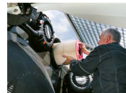
Cambio del filtro de aire sin herramientas
