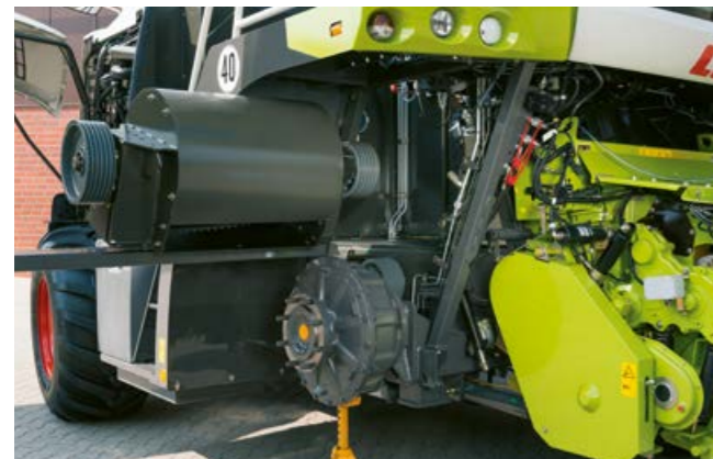
Sencillo desmontaje y montaje del acelerador
